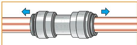
Для проверки надежности соединения потяните за трубку. Не забывайте проверять таким образом все соединения после их монтажа и/или перед первым испытанием системы.
