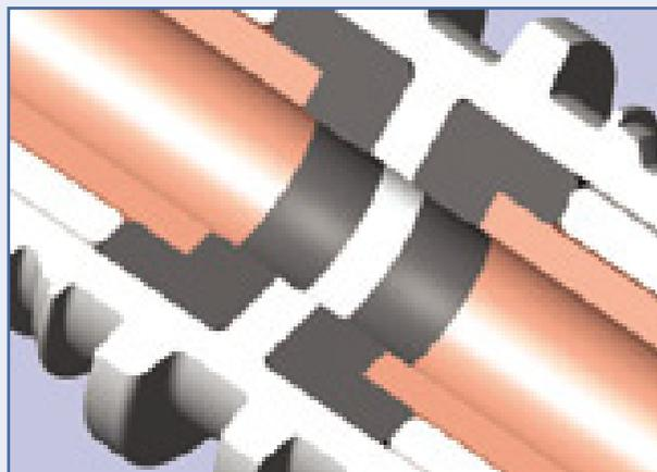
В обычных фитингах даже при правильном отрезании трубки может существовать зазор между окончанием трубки и упором внутри фитинга.
