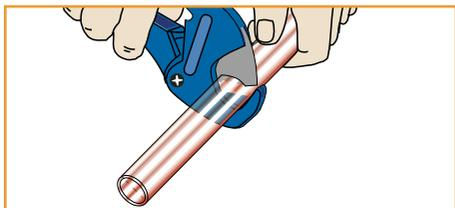
Отрежьте трубку необходимой длины так, чтобы плоскость среза была перпендикулярна продольной оси трубки. Перед установкой трубки в фитинг обработайте ее торцы, чтобы убрать острые кромки и заусенцы. Для мягких и тонкостенных пластиковых трубок мы рекомендуем использовать трубные вставки.
