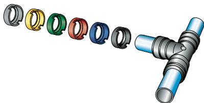
Защитные крышки предотвращают случайное отсоединение трубки от фитинга. Трубка может вставляться в фитинг при уже установленной на фитинг крышке, либо крышка может устанавливаться после соединения трубки с фитингом. При необходимости, крышка может легко сниматься. Крышки поставляются различных цветов, что позволяет производить соответствующую цветовую индикацию соединений и трубопроводов.
